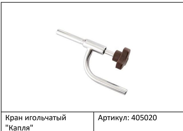
для покапельного отбора головных фракций на ректификационной колонне. Позволяет производить тонкую настройку скорости отбора спирта. Диаметр трубок соединения и отбора продукта – 8 мм, благодаря чему кран легко подключается к узлу отбора любого аппарата с помощью силиконового шланга.
