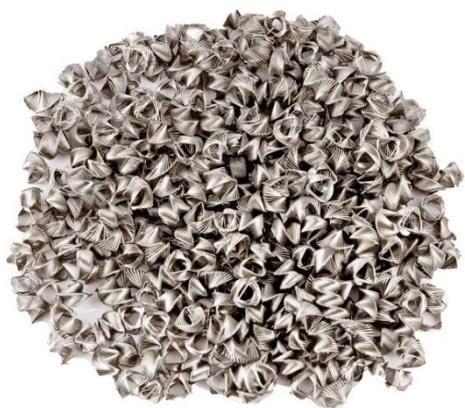
Спирально-призматическая насадка (далее СПН), используемая в ректификационных колоннах для увеличения степени очистки. Она позволяет получить более чистый самогон и спирт, фильтруя пары спирта от сивушных масел, различных примесей и добиваясь укрепления получаемого продукта на выходе дает чистый спирт при соблюдении процесса ректификации и достаточной высоты царг.
